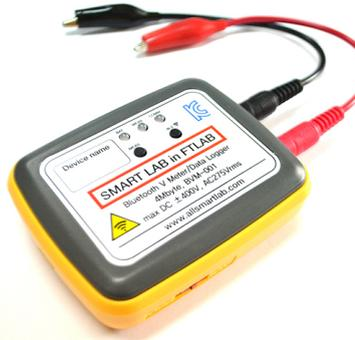
전압과 전류를 정밀하게 측정하고 4Mbyte까지 스스로 저장하는 무선 측정기로서 저전력으로 무인/장시간 측정이 가능하며 스마트기기를 이용해 최대 8개까지 동시에 측정 및 손쉽게 그래프 및 데이터 모니터링이 가능한 혁신적인 제품입니다
